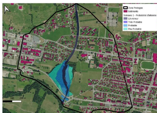
Figure 91 : Cartographie des probabilités d'atteintes pour le scénario 1 – fonctionnement nominal du système d'endiguement.
